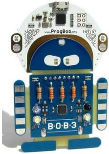
Auch der BOB3 basiert auf einem ATmega88. Er hat Tastsensoren, Photosensoren und „Augen“ in Form von RGB-LEDs. Eine IR-LED kann für eine Fernbedienung benutzt werden oder mit der IR-LED als Annäherungssensor.
