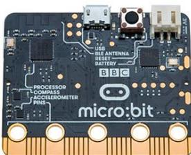
Der micro:bit ist dem Calliope sehr ähnlich. Er hat auch 25 LEDs, 2 Buttons, 3 Pins (für externe Beschaltung), Kompass, Bluetooth, einen USB-Anschluss und weitere Sensoren.
